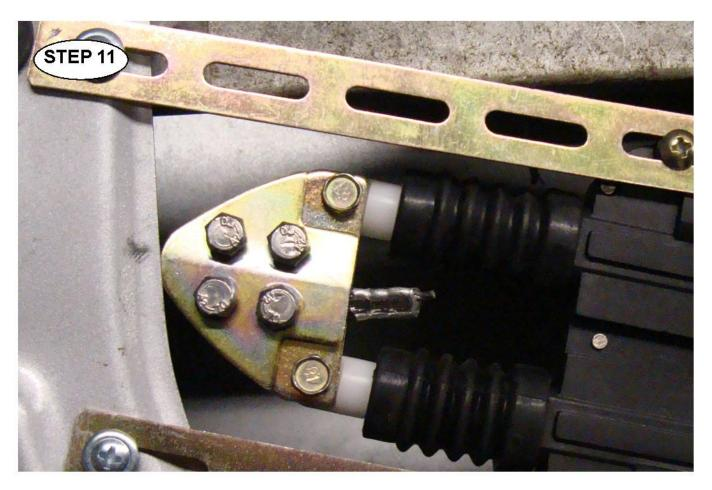
CUT OFF THE EXCESS CABLE THAT EXTENDS PAST THE FERRULE. REINSTALL THE CABLE BACK INTO THE CLAMPING PLATE. THE FERRULE SHOULD REST RIGHT UP AGAINST THE PLATE. TEST THE DOOR WITH THE REMOTE AGAIN TO MAKE SURE THAT EVERYTHING IS STILL IN ADJUSTMENT.
