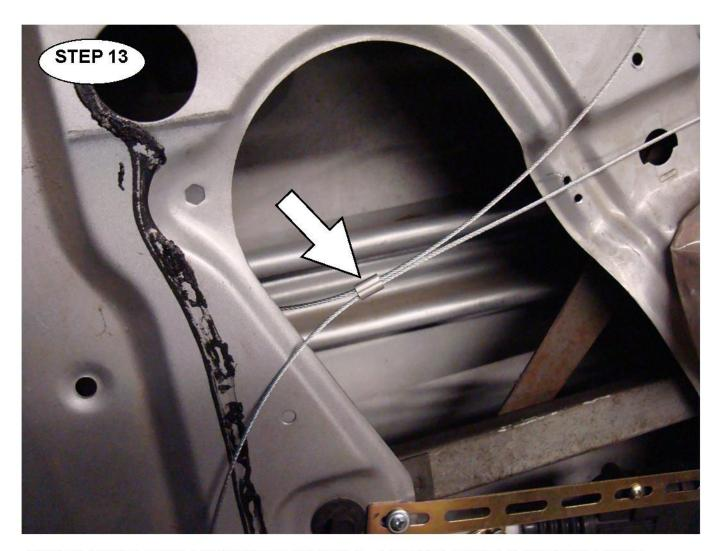
NOW PUT THE SHORT CABLE FROM THE LATCH AND THE CABLE FROM THE INTERIOR HANDLE INTO THE OVAL FERRULE. <u>DO NOT CRIMP YET!</u>
